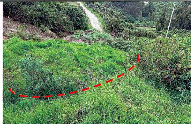
Fotografías 13 y 14. Superficie de falla mayor al material movilizado
